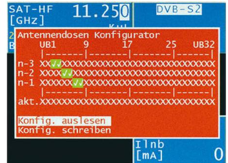
Konfigurationsmenü für programmierbare UNICABLE-/JESS-Antennendosen.
